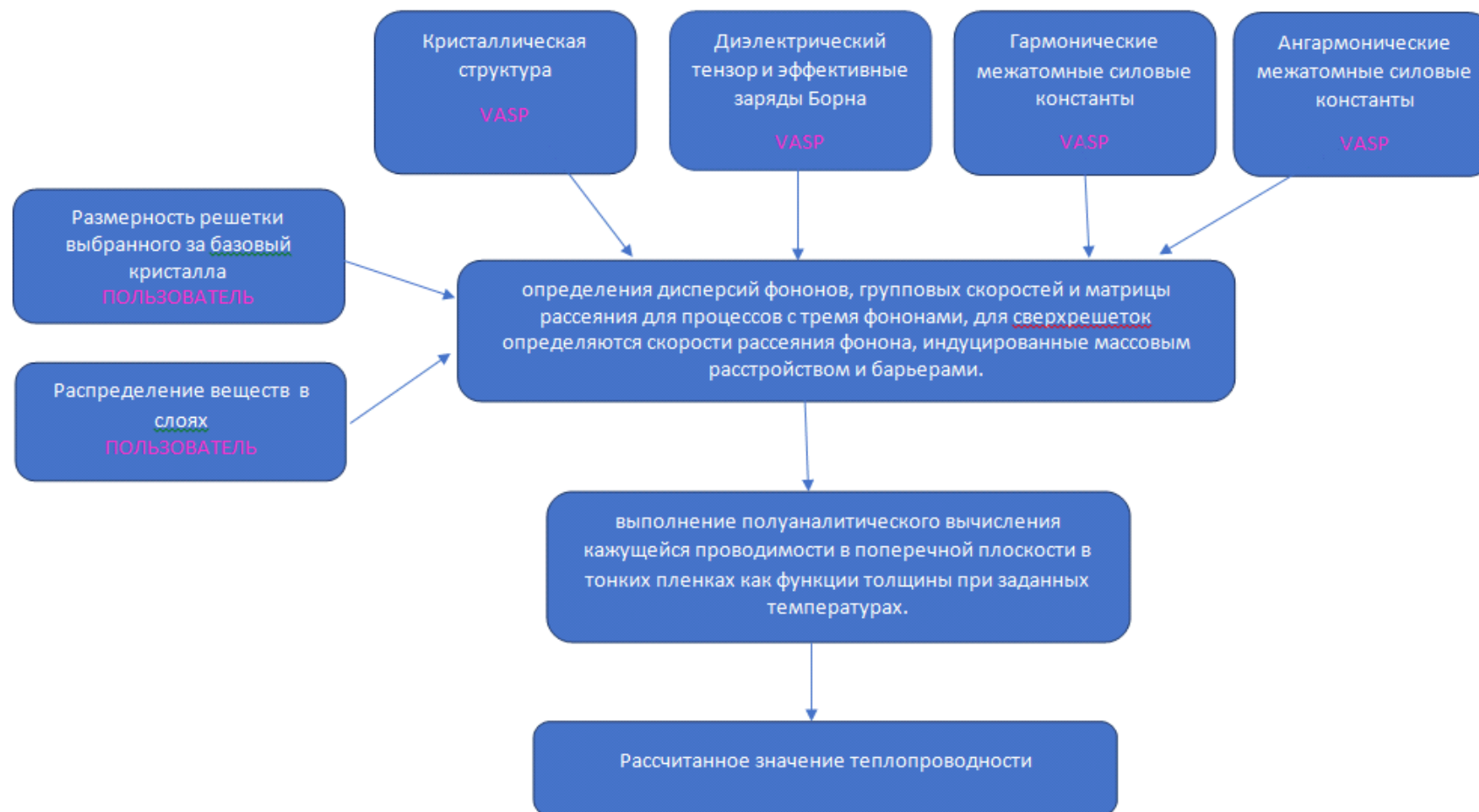
Рисунок 2.1 Алгоритм расчетов с использованием программного пакета almaBTE
