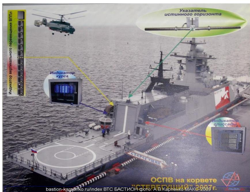
Рис. 1.1. Оптическая система посадки вертолета ОСПВ-20380
