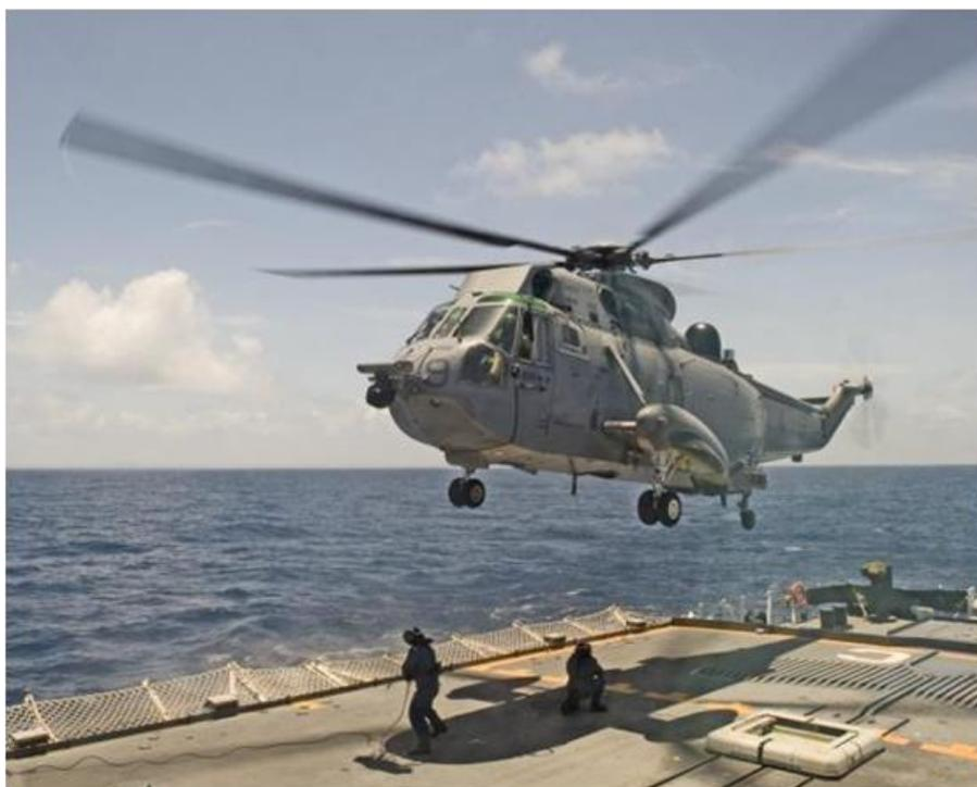
Рис. 1.3. Система принудительной посадки RAST (Recovery Assist, Secure and Traverse)
