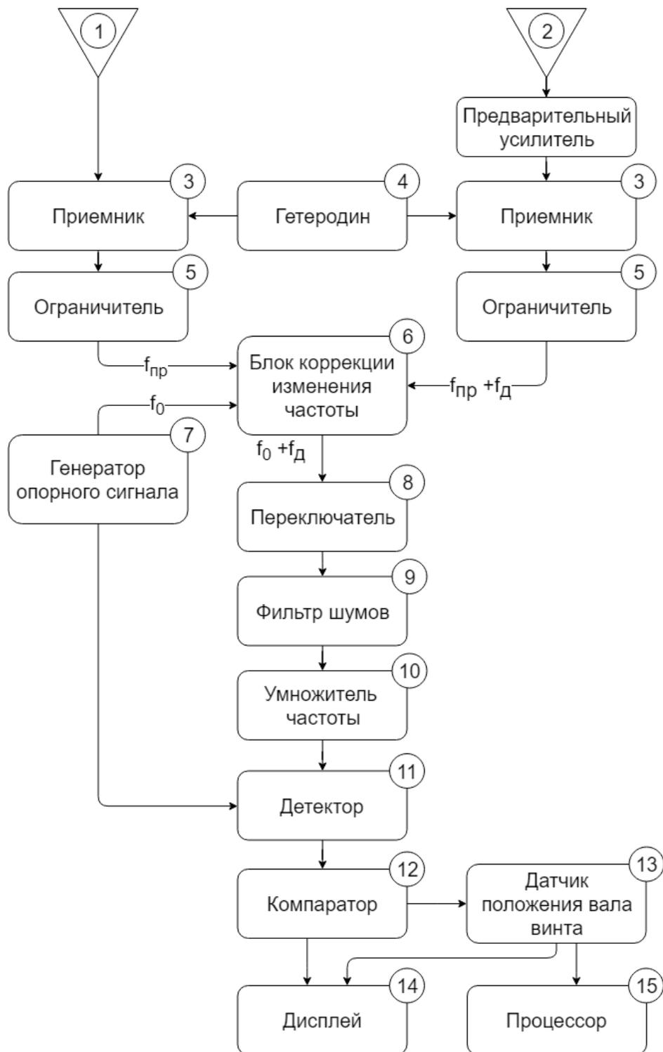
Рис. 1.5. Схема пассивной доплеровской системы определения направления
