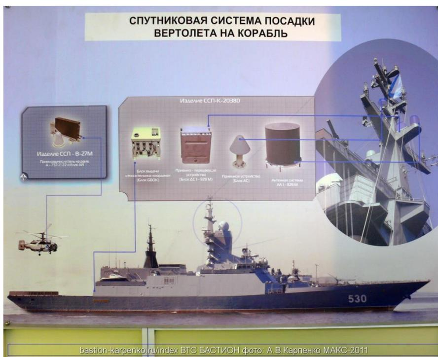
Рис. 1.2. Спутниковая система посадки вертолета на корабль ССП-К-20380
