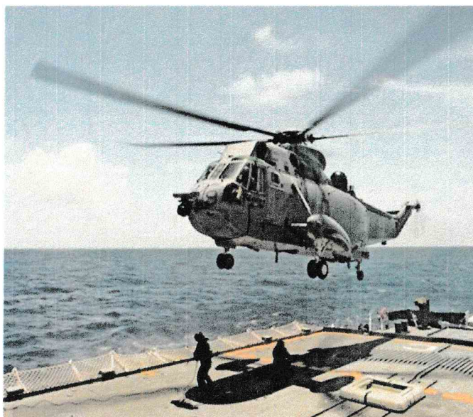
RAST (Recovery Assist, Secure and Traverse) - система обеспечения принудительной посадки, фиксации вертолѐта и его буксировки
